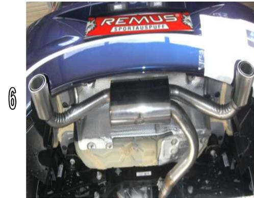
Klemm- oder Schraubverbindungen locker vorziehen. Den REMUS Sportschalldämpfer ausrichten und die Verbindungen fest anziehen. Motor kurz anlassen und den kompletten REMUS Sportschalldämpfer auf Dichtheit überprüfen. Sämtliche Bauteile, sowohl im kalten als auch im betriebswarmen Zustand auf Funktion und genügend Freigängigkeit überprüfen. Achten Sie dabei auf einen ausreichend belüfteten Montageaum.
